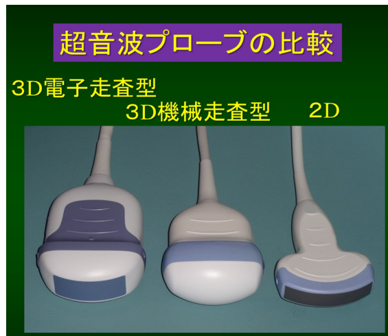
Fig. 11 3次元超音波プローブ 右の2D（超音波断層法）プローブは比較のため。
