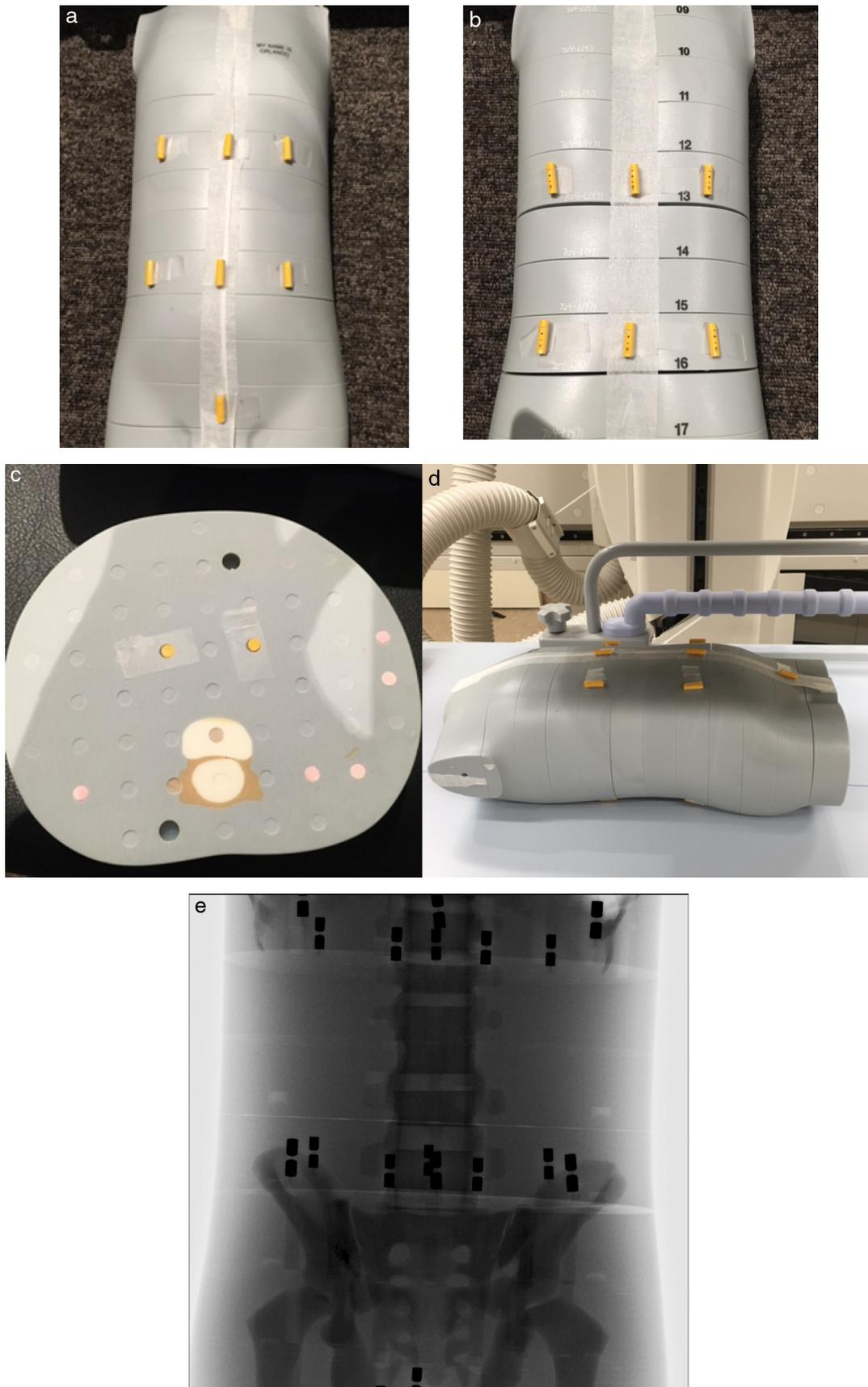
**Fig. 4** 実験に用いたファントムとガラス線量計
